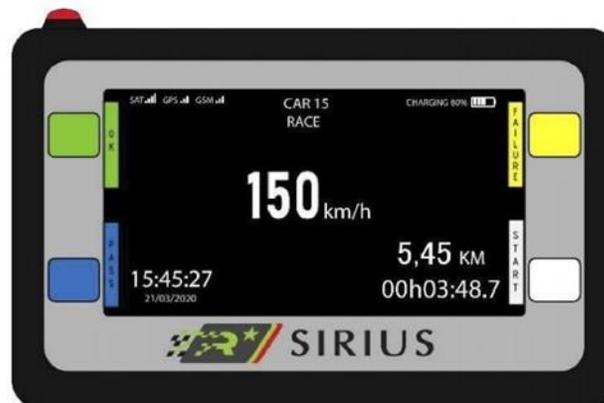
La pantalla principal nos da la información necesaria, en la parte superior derecha encontrarán los iconos de conexión (GSM Y/O SAT), en el centro, la velocidad actual SOG (150KM/H) parte inferior izquierda hora (15:45:27) y fecha (21/03/20), parte inferior derecha, odómetro (5,45 KM) y cronometro (00H03:48)
