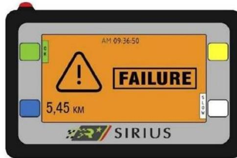
Si el competidor tiene un percance y queda detenido en el tramo, deberá presionar el botón amarillo por 3 segundos, este comando accionará el estado de “AVERÍA” .
